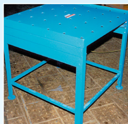
Stůl s ovládáním zasouvání jednotek pro posun a následnou fixaci břemene.
