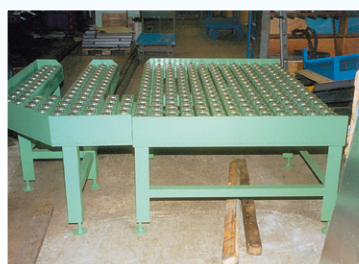
Speciální stůl pro lisovací nástroje s drážkami pro vidlice stohovacího vozíku
