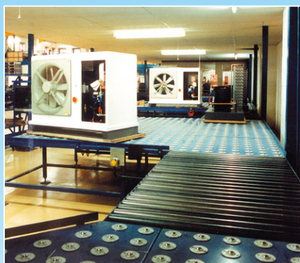
Kuličkové stoly jako součást montážní linky
