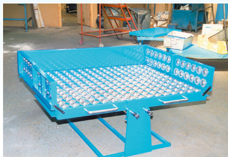
Naklápací kuličkový stůl pro gravitační rozduřování
